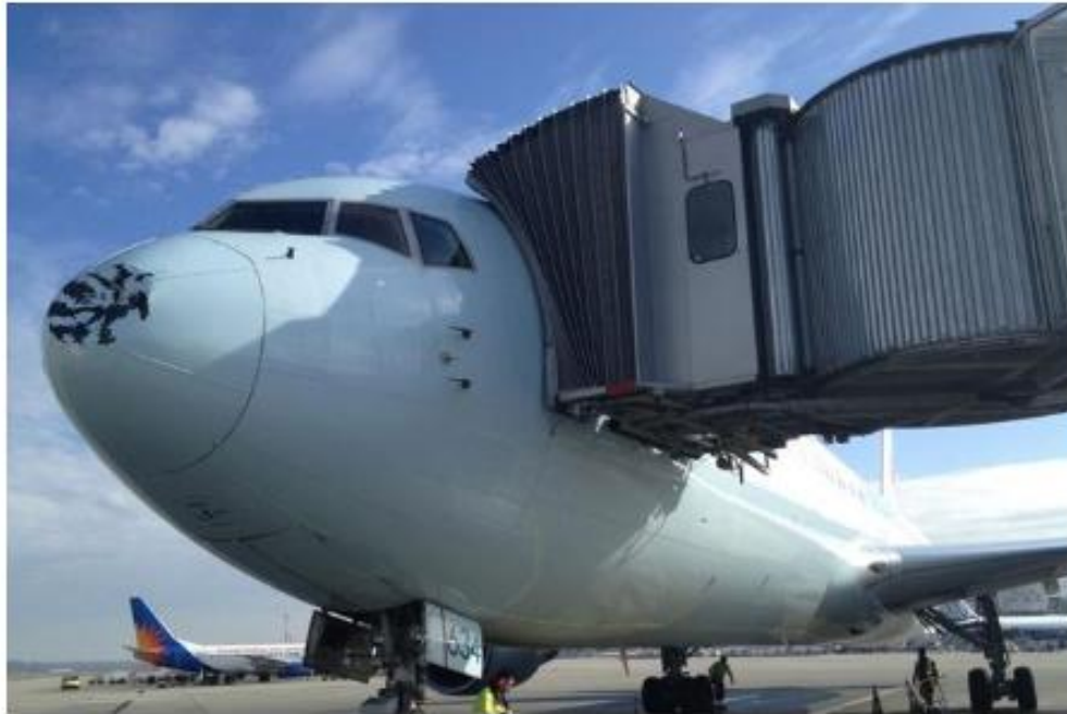
Un oiseau s'est écrasé contre le nez de ce Boeing 767 laissant un impact bien visible Image: Boris Otter (lecteur reporter)
